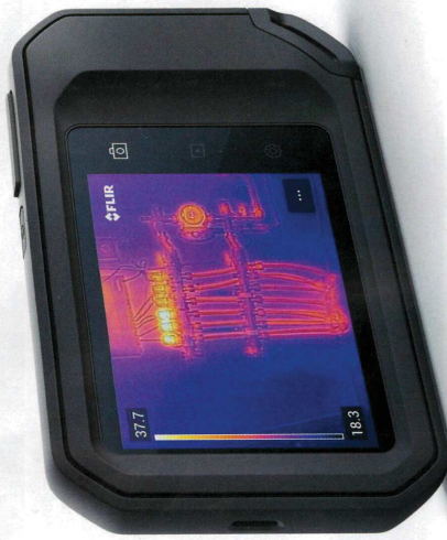
Lokalisiert: Defekte Sicherung (Kamera: Flir C5).
