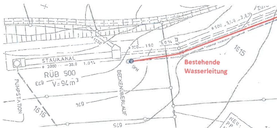
Abbildung 8: Lageplan mit bestehender Wasserleitung
